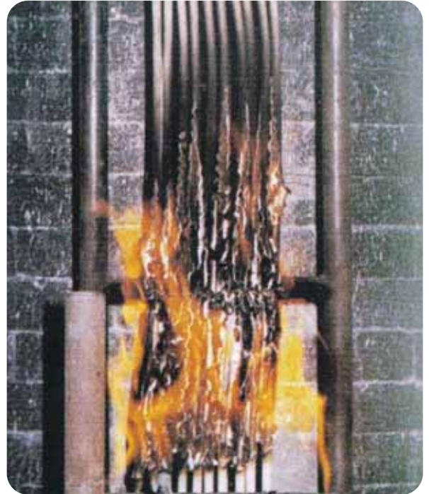
Alev iletme deneyinde AFUMEX™ kablo
