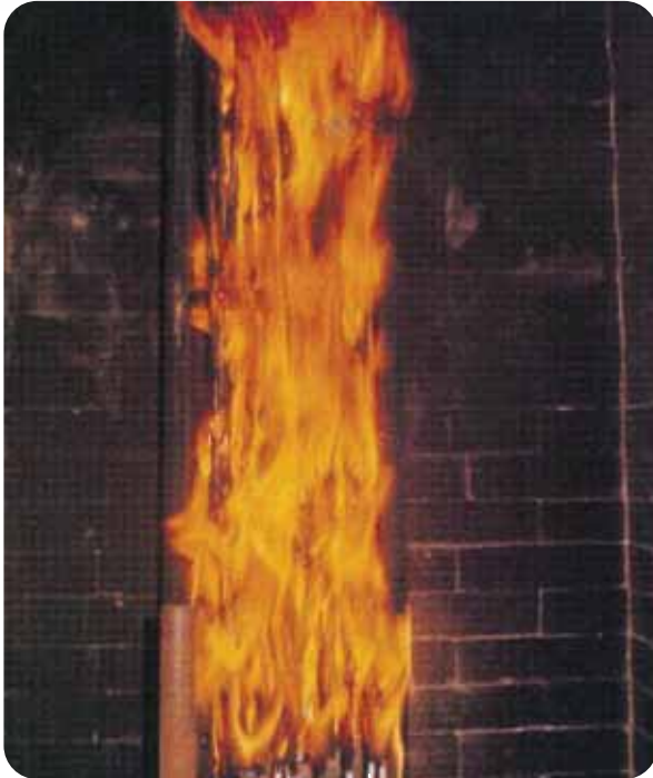
Alev iletme deneyinde standart PVC kablo
